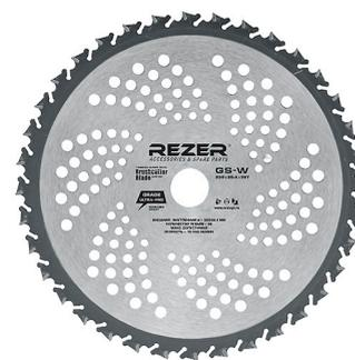
Ножи Rezer STANDARD серии GS-W Ultra-Pro со специальной противоударной формой зуба обеспечивают повышенную устойчивость к ударам о твердые предметы. Облегченная конструкция ножа снижает уровень вибрации и увеличивает ресурс редуктора косы.
