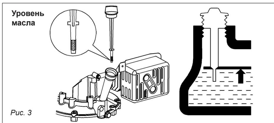
**Проверка уровня масла.** Выверните пробку-щуп из масляной заливной горловины, протрите его и вставьте обратно без закручивания. Выньте и проверьте уровень масла: если уровень низкий долейте масло. Используйте моторное масло для 4-х тактных двигателей стандарта SAE30. Объем картера двигателя составляет 0,4 л.
