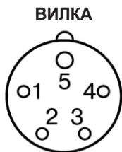
Рис. 4. Схема расположения контактов на вилке
