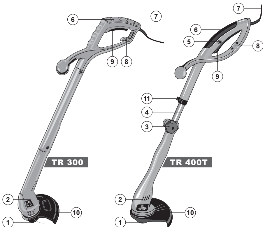
Рис.2. Расположение основных элементов электротриммера:
