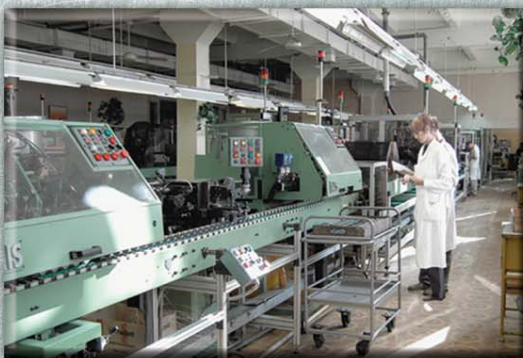
Производство якорей электроинструмента на итальянской линии AXIS.
