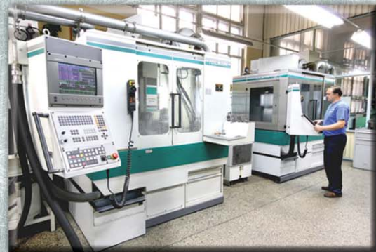
Изготовление оснастки на фрезерных обрабатывающих центрах с ЧПУ "PICOMAX" "FEHLMANN" (Швейцария). Manufacturing of equipment on HPM machining centers "FEHLMANN" (Switzerland) and CNC «Picomax».
